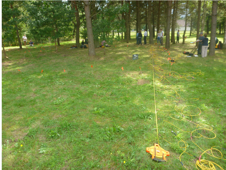
4. ERT-2 profilio vieta, sujungti elektrodai ir paleista elektros srovė. Vaizdas iš ŠR.
