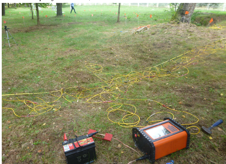
3. ERT-1 profilio vieta, sujungti elektrodai ir paleista elektros srovė. Vaizdas iš P.
