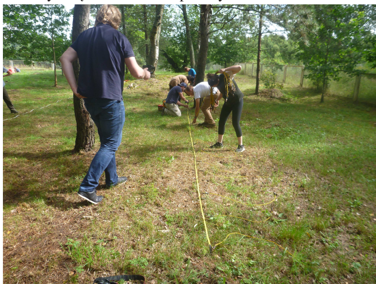
2. ERT-1 profilio vieta, sukalami elektrodai. Vaizdas iš PV.
