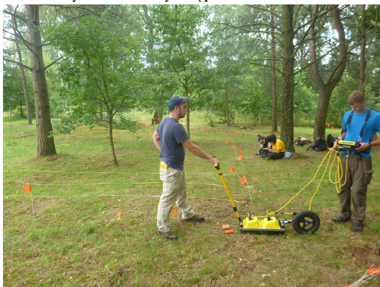
8. GPR tyrimų plotas 1 skanuojamas 250 Mhz anten. Vaizdas iš ŠV.
