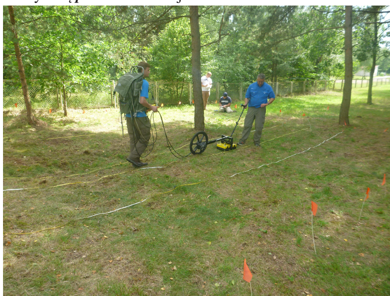
9. GPR tyrimų plotas 2 skanuojamas 450 Mhz antena. Vaizdas iš Š.
